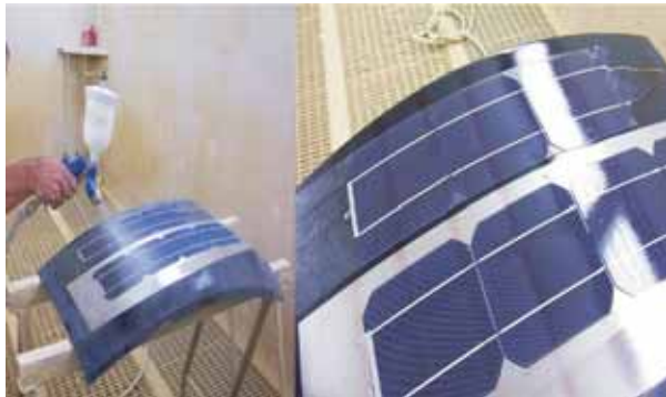
Şekil 3. Güneş Hücrelerinin Birleştirilmesi ve Koruyucu Kimyasal ile Kaplanması
