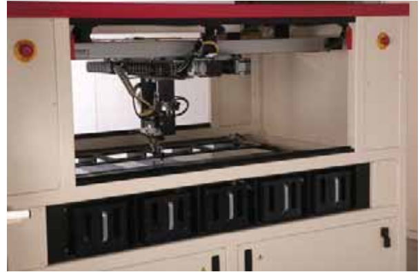
Şekil 3. Performansa göre ayrılan gözeler sınıflandırılarak göze kasetlerine yerleştirilir.
